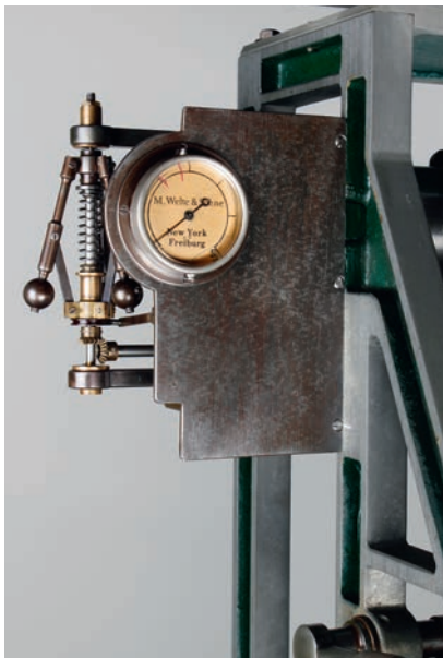
Der Drehzahlmesser an der Aufnahmespule des Aufnahmeapparats. The speed gauge on the drive-reel of the Welte recording device. Le compte-tours sur le rouleau d'enregistrement de l'appareil enregistreur.
